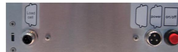
**Load cell (célula de carga):** Pin 1 → Alimentación positiva
